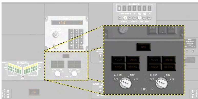
**Indicación GPS:** Esta luz encendida indica una falla en ambos sistemas GPS.
