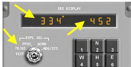
El modo PPOS (present position) indica la actual posición geográficas de la aeronave. Esta información puede ser ingresada manualmente por el piloto, utilizando el teclado alfanumérico.
