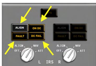
**Indicación ALIGN:** Cuando se ilumina de forma fija, el IRS respectivo está funcionando en modo ALIGN, en modo initial ATT, o en ciclo de apagado.
