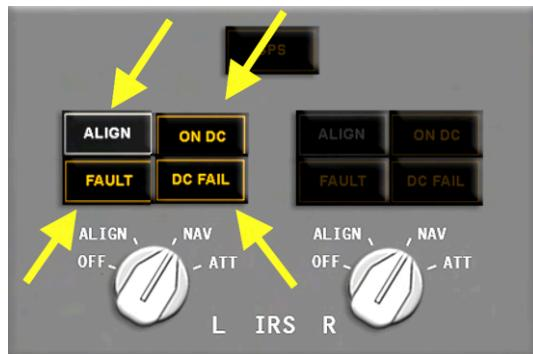
**Indicación ON DC:** Cuando se ilumina, el IRS respectivo está funcionando en corriente directa proveniente de la barra de la batería. Su iluminación temporal es normal durante el ciclo de testeo del sistema.
