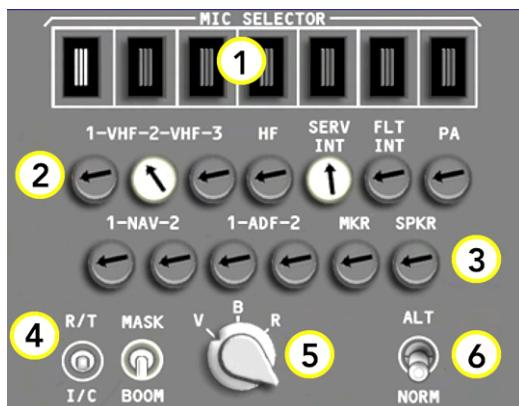
El punto cuatro representa dos perillas. La de la izquierda, PPT (push to talk), con dos posiciones: R/T para transmisiones de radio; y I/C para transmisiones de intercomunicación con el resto de la tripulación y la cabina de pasajeros. La segunda perilla posee dos posiciones: MASK para activar el micrófono de la máscara de oxígeno, y BOOM activar el micrófono para otras transmisiones.
