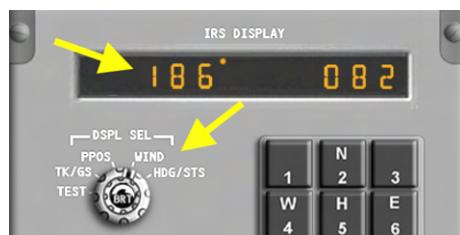
Finalmente, el modo HDG/STS indica el rumbo de la aeronave y un código de mantenimiento que indica el estado del sistema.
