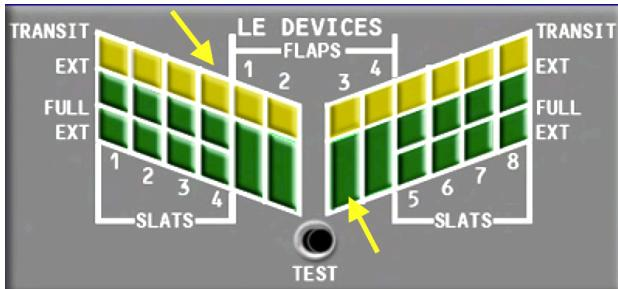
El diagrama informa tres situaciones de los dispositivos hipersustentadores: dispositivos en tránsito, dispositivos extendidos parcialmente, y dispositivos extendidos en su totalidad. El botón central de testeo (TEST), verifica el funcionamiento de la iluminación del display, pero no informa del funcionamiento de los dispositivos hipersustentadores.
