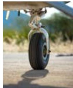
En las aeronaves equipadas con tren de aterrizaje convencional, este sistema de direccionamiento de la rueda de nariz no está disponible. En estos casos, el piloto debe dirigir el rodaje de la aeronave ejerciendo presión sobre los pedales para cambiar la dirección del timón de dirección o rudder.
