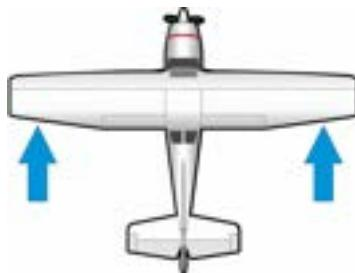
Esta superficie alar trabaja de forma asimétrica con su similar ubicada en el mismo sector del otro plano o ala del avión, es decir: “cuando un alerón sube, el otro baja”, logrando el siguiente movimiento con el cual concluimos que el avión gira sobre su “eje longitudinal”, generando un movimiento llamado “ALABEO”.
