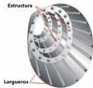
En los fuselajes semi monocasco, los largueros y los marcos endurecen la piel (superficie o pared), y las cargas de vuelo se comparten entre la piel y la estructura debajo. Los mamparos se colocan en su lugar para separar las diferentes secciones del fuselaje; por ejemplo, entre el compartimento del motor y el compartimento del pasajero.
