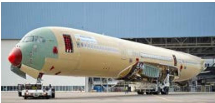
Luego está la construcción monocasco, que se utilizó principalmente a principios del siglo XX. Finalmente, está el fuselaje semimonocoque que se utiliza en la mayoría de los aviones que no sean no presurizados.
