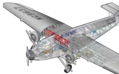
Las aberturas deben reforzarse para mantener la integridad de la estructura. Pero, una vez que las puertas de la aeronave están cerradas y todas las escotillas y los paneles de acceso están instalados, el fuselaje es, a todos los efectos, una estructura monocasco. Dos aviones construidos de acuerdo con el principio monocasco fueron la construcción de madera contrachapada Roland CII (1915) y el Ford Trimotor (1926).
