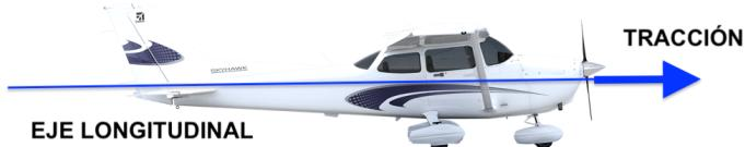
La capacidad de tracción que posee una aeronave se define como “Potencia” y esta depende de factores como: la forma y tamaño de la hélice, octanaje del combustible, densidad del aire, etc. La capacidad de tracción o potencia se mide en caballos de fuerza (HP), en motores convencionales y de kilos o libras de empuje en motores a reacción.
