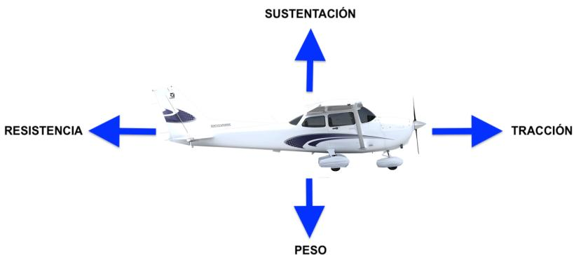
Estas cuatro fuerzas actúan en pares; la sustentación es opuesta al peso, y el empuje o tracción a la resistencia. Un avión o cualquier otro objeto, se mantiene estático en el suelo debido a la acción de dos fuerzas: su peso debido a la gravedad que lo mantiene en el suelo y la inercia o resistencia al avance que lo mantiene detenido.
