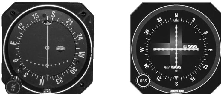
El instrumento de la izquierda es un receptor VOR con una sola aguja para indicar el radial que recibe de la antena. Por otro lado, el de la derecha es un receptor ILS con dos agujas, una vertical que recibe la información del localizador y otra horizontal que recibe la información del glide slope.
