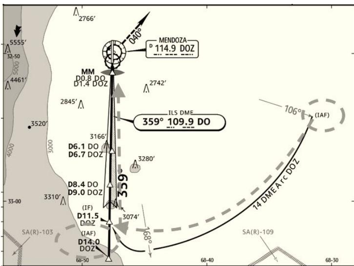
La segunda consideración a tener en cuenta es que para esta carta en especial, existen dos IAF o dos puntos de inicio diferentes, en diferentes lugares y con diferentes intenciones de operación. Este segundo IAF esta en la parte inferior dentro del circulo punteado y propone, únicamente, iniciar su aproximación final desde allí con el curso final hacia la pista.
