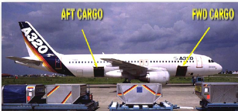
Tanto en la bodega delantera como en la bodega trasera existe la posibilidad de guardar los contenedores que se muestran en la imagen y dependiendo de la configuración de cada aeronave, una de estas bodegas puede ser presurizada para el transporte de animales vivos y/o cualquier otro elemento que requiera de un ambiente estándar de temperatura, presión y oxígeno.
