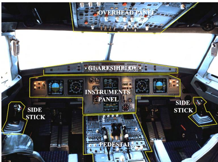
En la parte superior, encontramos a la sección denominada “OVERHEAD PANEL”. Debajo de este, se ubica el “GLARESHIELD” y justo debajo se ubica el “INSTRUMENT PANEL”. En el centro de la cabina, entre los dos asientos, se ubica la sección conocida como PEDESTAL PANEL. Y a los costados de cada asiento de los pilotos se ubica el control de mando conocido como “SIDESTICK”. Veamos mas de cerca cada sección:
