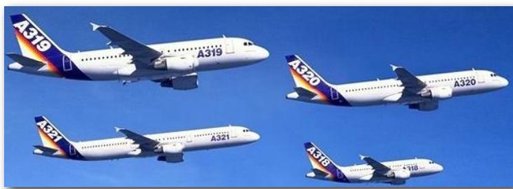
Con un peso máximo de despegue de MTOW (maximum takeoff weight) 77.000 kg, el 320 tienen un alcance de 2900 Millas Náuticas. Los otros modelos:
