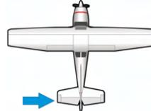
El timón de profundidad está situado en la cola del avión, paralelo a la posición de los alerones. Esta última superficie de control, gobierna el movimiento realizado sobre el “eje transversal” del avión y se conoce como “*Cabeceo*”. Esta será la superficie de control principal para realizar los procedimientos de ascenso y de descenso.
