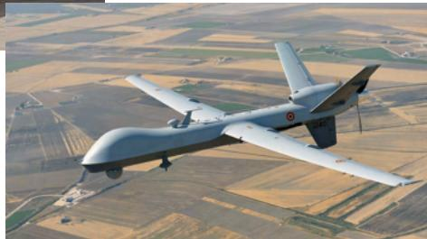
Contaba con una autonomía de 450 millas y hasta 16 horas de video en tiempo real de vigilancia en color y en alta definición, cámaras de visión infrarroja y SAR (Radar de Apertura Sintética) antes de volver a la base. Era controlado por un equipo en tierra usando una conexión satelital.
