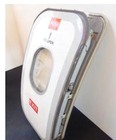
bisagras, las salidas de emergencia, son ventanas separadas de la estructura del fuselaje que pueden ser destrabadas y expulsadas hacia el exterior por el personal de cabina. Esto permite una vía de evacuación adicional dando lugar a los pasajeros a escapar desde el interior de la aeronave hacia la superficie del ala.
