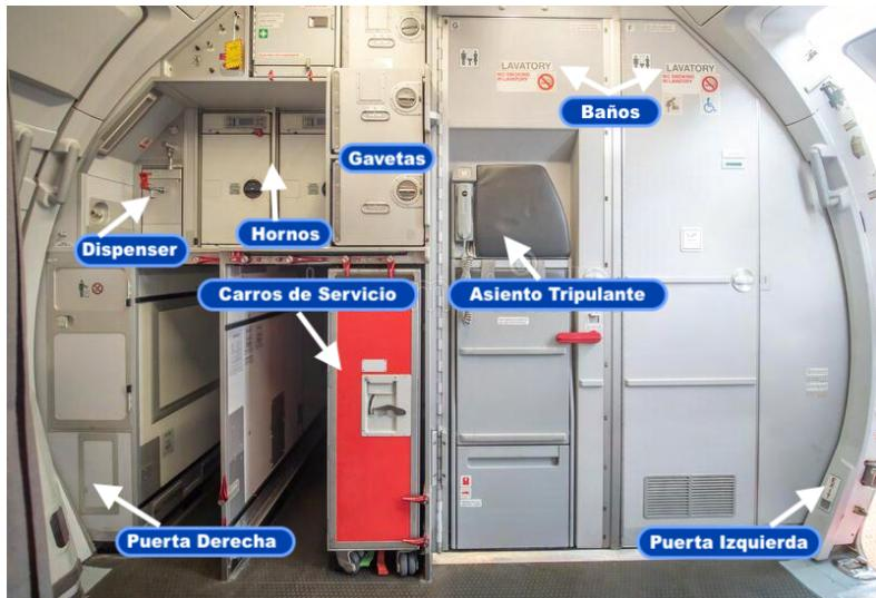
Independientemente del cambio en el diseño del galley, el sistema y diseño de puertas sigue siendo el mismo. Las cuatro puertas del avión poseen un sistema de bisagras que permiten su apertura hacia el exterior y hacia un costado del fuselaje, dando lugar a la operación de los puentes móviles para el ascenso y descenso de pasajeros.
