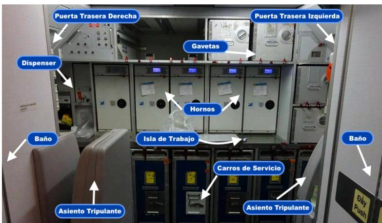
Con el constante avance de la tecnología en la industria aeronáutica, los fabricantes de aeronaves buscan constantemente actualizar el diseño de sus aviones a fin de maximizar las prestaciones en cada operador. Debido a ello, la flota de A320 presenta una variante al diseño del galley trasero, ubicando los baños sobre el fondo del avión a fin de poder ubicar dos filas mas de asientos. La siguiente imagen representa la disposición de este tipo de galley trasero.
