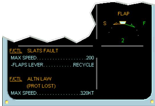
El ECAM advierte que el sistema de slats ha fallado. Indica una máxima velocidad de 200kt y requiere de una acción para reciclar la palanca de flaps, llevándola a cero y nuevamente a la posición deseada, en caso de que esta acción solucione la falla. Seguidamente, el ECAM advierte que la aeronave se ha degradado a ley alterna de vuelo, perdiendo las protecciones de la ley normal de vuelo.
