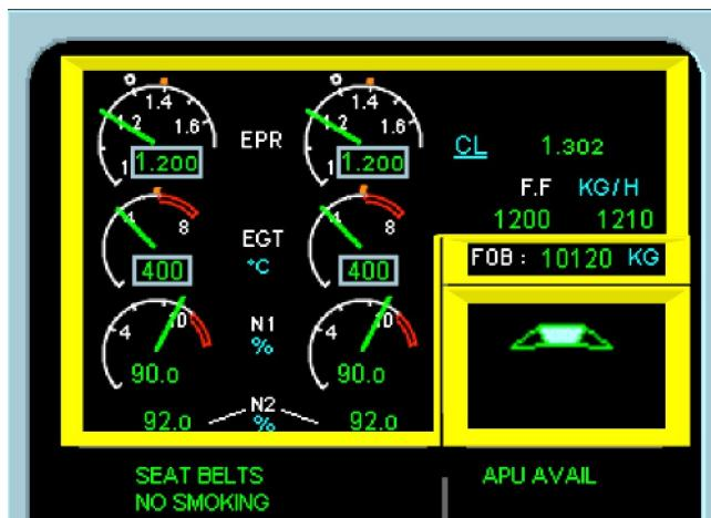
En condiciones normales, la parte inferior del EWD se utiliza para mostrar MEMOS. En el ejemplo que se muestra, los memorandos indican
