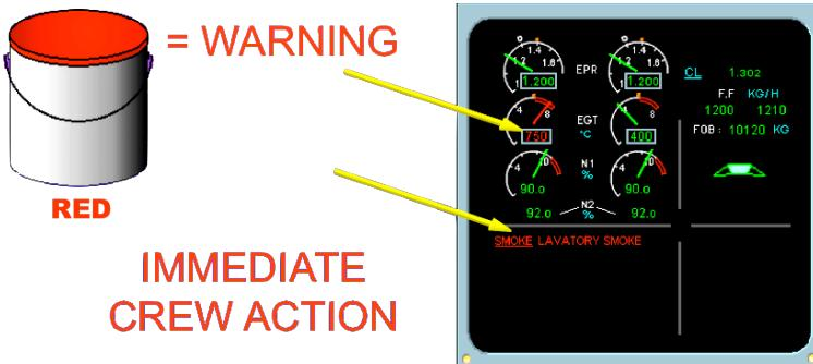
El EWD se divide en dos partes principales. El área superior se utiliza para los parámetros principales del motor, el combustible a bordo y la posición de Flaps.
