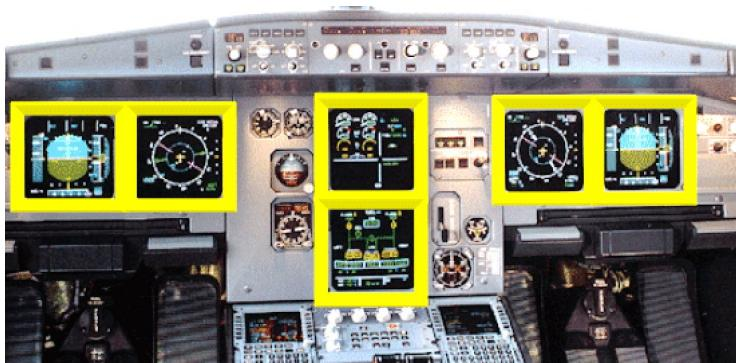
Los parámetros de vuelo se muestran en las pantallas de vuelo principal (PFD primary flight display), mientras que los datos de navegación se muestran en las pantallas de navegación (ND navigation display).
