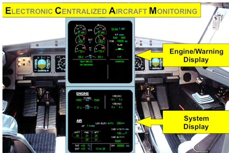
La presentación de la información del sistema se basa en una filosofía de "Necesidad de saber". Esto significa que solo se presenta a los pilotos la información del sistema relevante para la fase particular del vuelo. El sistema ECAM vigila todos los sistemas de la aeronave y los monitorean en busca de estados anormales. Si se detecta algo anormal, el ECAM alertará a los pilotos y proporcionará una lista de verificación electrónica para ayudar a manejar la anomalía.
