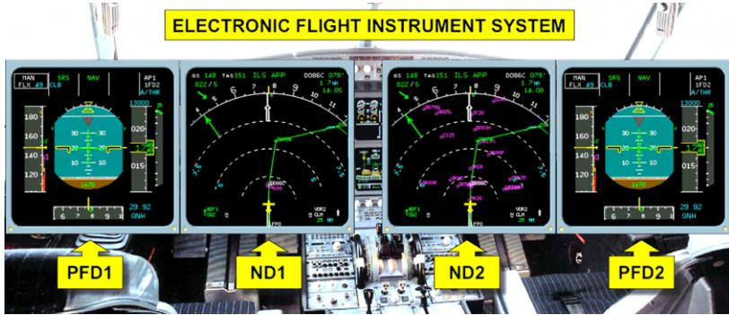
Fuera del PFD, hay perillas de control para ajustar el brillo del PFD y ND asociados, o para apagar la pantalla.
