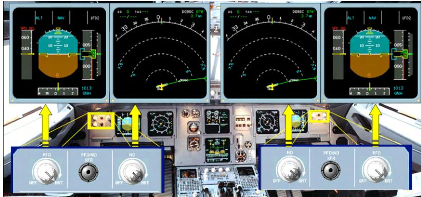
Las dos pantallas del centro están dedicadas al sistema de monitoreo electrónico centralizado de la aeronave (ECAM). Las pantallas se dividen en dos, la superior o EWD y la inferior o SD:
