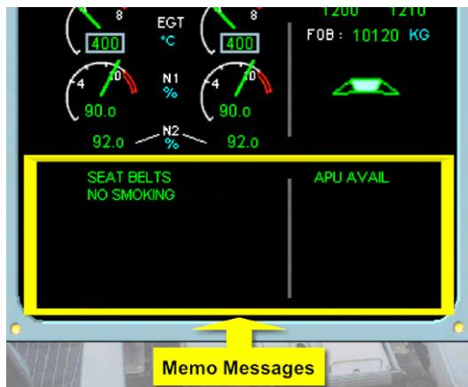
Si se producen fallos, los mensajes de advertencia y/o precaución se muestran en lugar de las notas. En este ejemplo hay un mensaje de advertencia ámbar con una serie de elementos de acción azules. Estos elementos de acción son su lista de verificación electrónica para responder a la situación anormal en particular.
