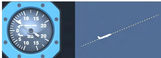
El alcance de la tolerancia al error se llama Límite de Alerta (AL) y se designa en el plano horizontal y vertical. El valor de AL se determina por separado para cada especificación. Las alertas se emiten si los parámetros exceden los límites predeterminados. Sin embargo, cada sistema se caracteriza por Time To Alert (TTA), que muestra cuánto tiempo pasa desde el momento de la violación de AL hasta que se emite la alerta.
