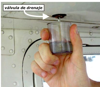
Adicionalmente a la válvula de drenaje de cada tanque, existe un control de drenaje ubicado en el motor con el fin de drenar el combustible que ya ha salido del tanque y se encuentra alojado dentro del circuito de combustible. Desde la tapa de inspección del motor se puede ver y operar este control.
