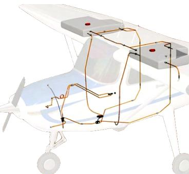
Observando la siguiente imagen podemos ver un tanque real en su cavidad dentro de el ala del avión. En su extremo cuenta con una tapa de carga de combustible de operación manual.
