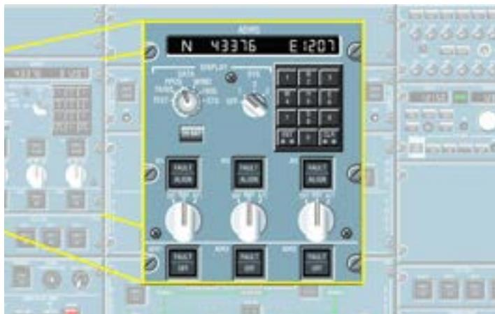
Sobre el centro del panel se encuentran tres perillas giratorias, una para cada sistema inercial, que le permiten al piloto seleccionar el modo de uso de cada sistema. Arriba de cada perilla, un indicador visual de alineación en progreso, o sistema en falla. Justo debajo de cada perilla, otras tres indicaciones visuales correspondientes a los sistemas ADR indicando alguna anomalía (fault) o simplemente el sistema en OFF.
