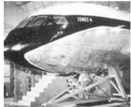
Los simuladores empezaron a ser construidos con seis ejes de movimiento (cabeceo, balanceo y alabeo para los movimientos angulares y movimientos horizontales, verticales y laterales). A partir de 1977, los simuladores de aerolínea empezaron a adoptar las
