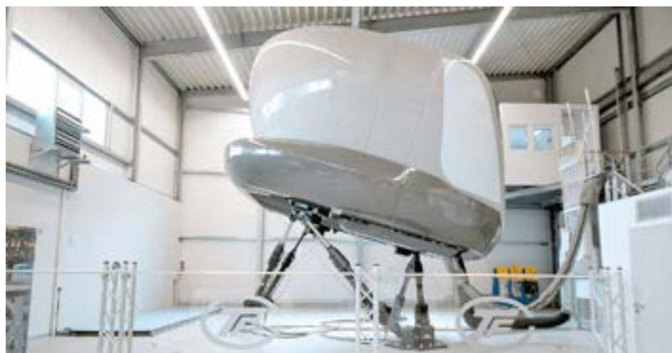
Los simuladores también se conocen por sus siglas, FSTD (*flight simulation training devices*, en español dispositivos de entrenamiento de simulación de vuelo). Los FSTD que usan los pilotos para formarse suelen ser FFS, esto es, *full motion flight simulator* o simulador de movimiento completo. Estos
