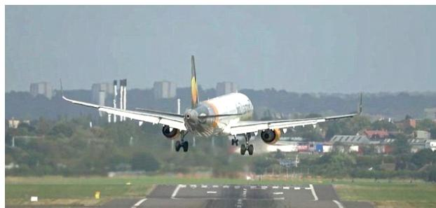
**Viento para el Despegue y Aterrizaje:** El viento cruzado máximo demostrado es de 38 kt (ráfaga incluida). El valor máximo de viento cruzado demostrado es la condición máxima de viento cruzado experimentada durante las pruebas de certificación de la aeronave. No se recomienda operar intencionalmente en vientos cruzados que excedan este valor.
