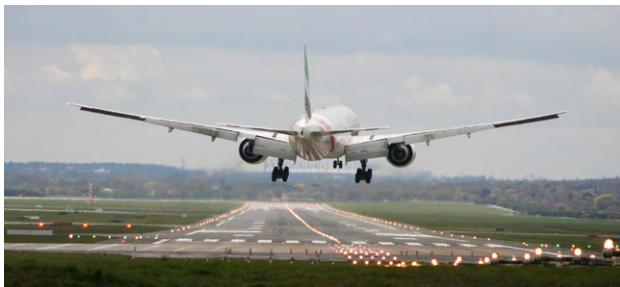
Para las operaciones de despegue y aterrizaje, el límite del componente de viento de cola de 15 kt, teniendo en cuenta las mismas condiciones anteriores, donde el fabricante establece este valor en función de las pruebas de certificación.
