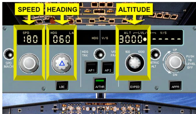
A su derecha, debajo del valor del rumbo, una perilla giratoria con un triángulo de color azul que permite seleccionar el rumbo. Cuando el piloto automático esté conectado, al girar esta perilla, el avión realizará un viraje hacia el lado seleccionado.
